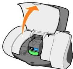
A menos que la impresora esté ocupada, el carro del cartucho de tinta se desplazará hasta la posición de carga.
